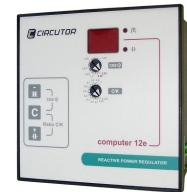
از جمله تجهیزات تابلوی بانک خازنی رگولاتور است. این دستگاه بر اساس ضریب توان شبکه تشخیص می دهد چه مقدار خازن باید به مدار وصل شود تا ضریب توان مطلوب به دست آید
