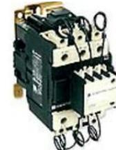
در تابلوهای خازنی جهت وارد کردن خازنها به مدار شبکه از این کنتاکتورهای مخصوص استفاده می کنیم این کنتاکتورها دارای یک مقاومت جهت محدود کردن جریان های هجومی ناشی از اتصال خازنها به مدار هستند
